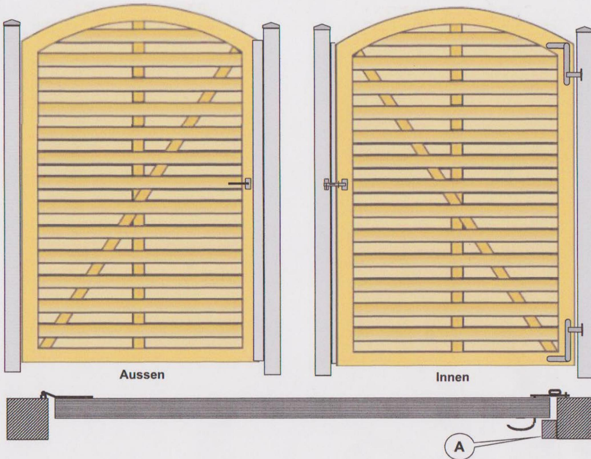
Bei der Montage von Sichtschutztüren empfehlen wir, die Beschläge wie auf dieser Zeichnung dargestellt anzubringen. Auf diese Weise ist es möglich, das Tor mit einem Vorhängeschloss zu sichern.
